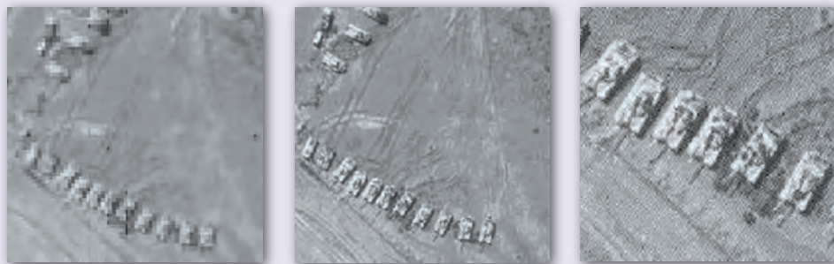
Detekcja (z lewej) – zobrazowanie 1,5 m – umiejscowienie obrazu pojazdu, obiektu wyróżnia się spośród naturalnych cech terenowych i innych obiektów. Rozpoznanie (w środku) – zobrazowanie 0,5 m – określenie kształtu, stosunku długości do szerokości i obecności głównych elementów pojazdu. Identyfikacja – zobrazowanie 0,15 m – określenie specyficznego typu i modelu pojazdu wojskowego, rozróżnienie za pomocą widzenia stereoskopowego położenia oraz kształtu wszystkich elementów
