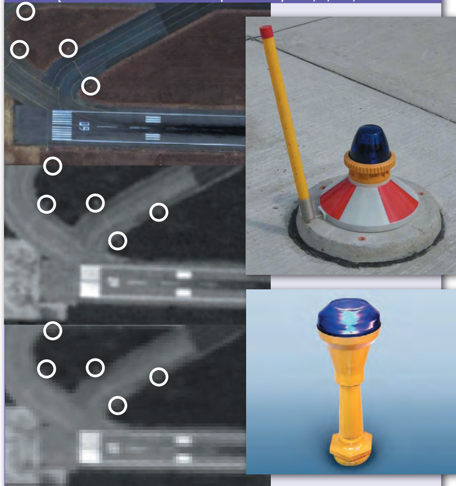
RYS. 3. ŚWIATŁA DROGI KOŁOWANIA (ZAZNACZONE BIAŁYMI OKRĘGAMI) NA ZDJĘCIACH O ROZDZIELCZOŚCI (OD GÓRY): 1 M; 2,5 M; 5 M
