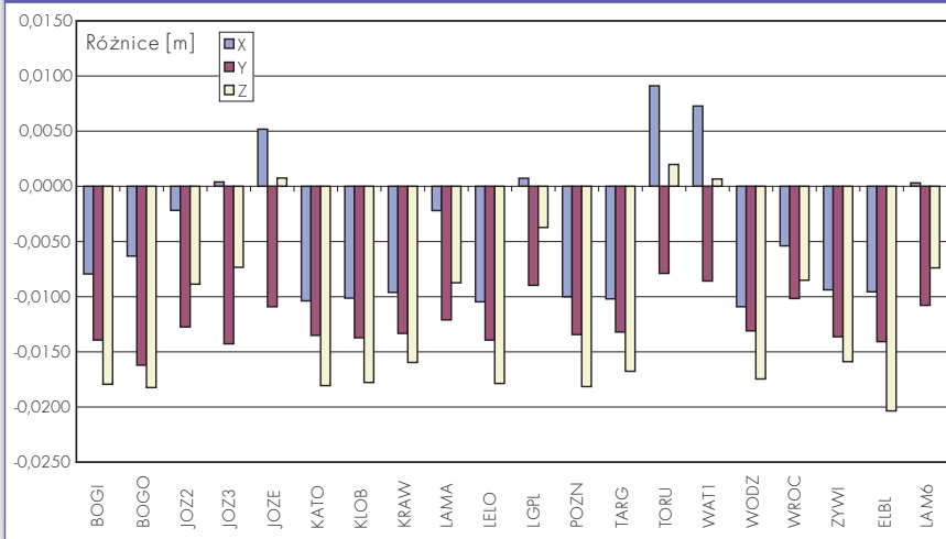
RYS. 3. RÓŻNICE WSPÓŁRZĘDNYCH GEOCENTRYCZNYCH W SYSTEMIE ETRS'89, REALIZACJA ETRF2000 I ETRF2005
