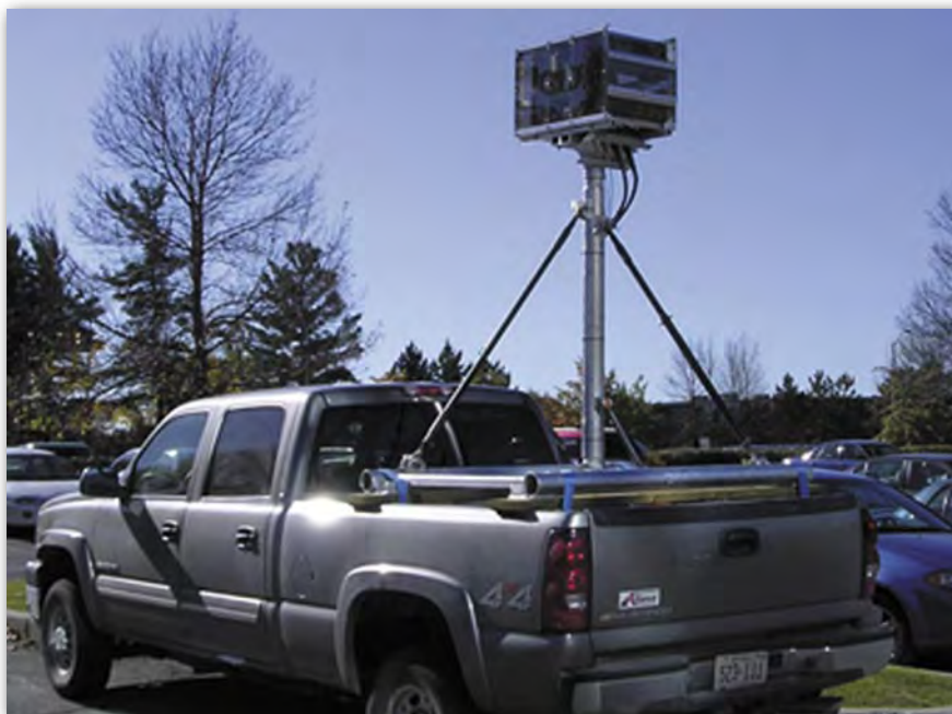
Rys. 6. Zestaw TITAN do dynamicznego skanowania 3D opracowany przez firmę Terrapoint. TITAN wykorzystywany był między innymi do inwentaryzacji pasa drogowego autostrady nr 1 w Afganistanie. Źródło: Terrapoint
