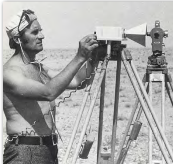
Marzec 1977 r., Lochais, Zbigniew Grodzicki podczas pomiaru fotopunktu dalmierzem mikrofalowym CA-1000
