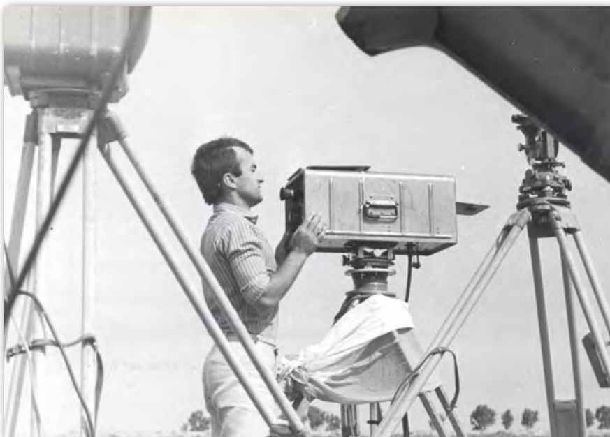
Marzec 1977 r., Al-Aligharbi, Roman Pieprzycki, sprawdzanie gotowości instrumentu geodimeter do pracy
