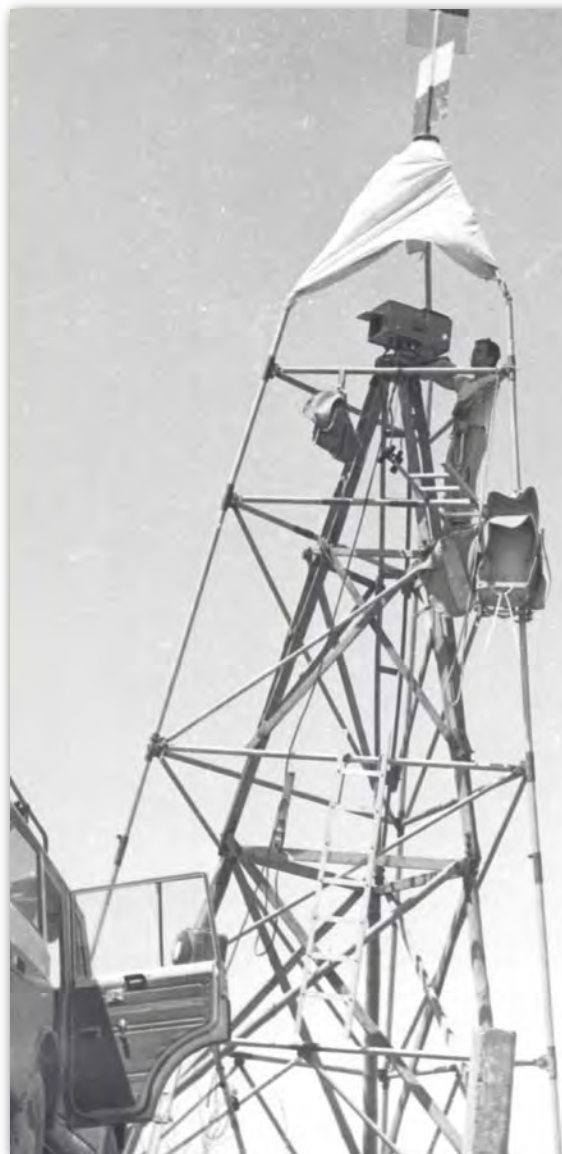
1977 r., Al-Aligharbi, pomiar na polskiej wieży „6x9” prowadzi R. Pieprzycki, dalmierz Aga-8
