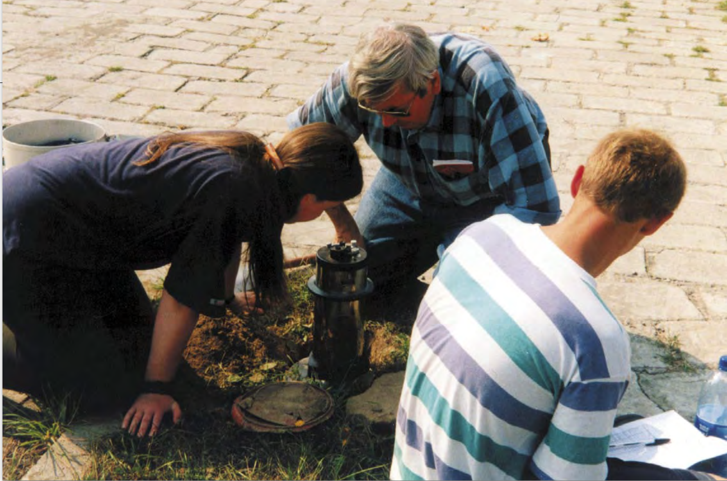
Autor artykułu wraz ze studentami wykonuje pomiary grawimetrem Worden w ramach badań Pienińskiego Poligonu Geodynamicznego
