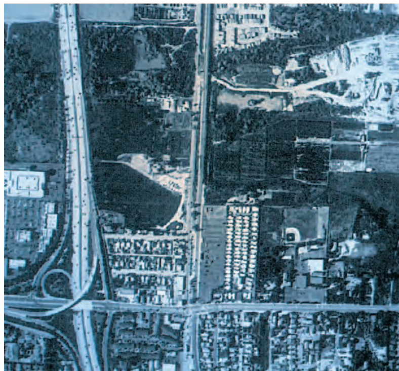
Rys. 1 (powyżej). Obraz rejonu San Diego w USA z rosyjskiego satelity DD-5 o terenowej zdolności rozdzielczej 2 m. Szerokość pasa zobrazowania 14 km. Widoczna autostrada z jadącymi samochodami, ulice osiedla i domy jednorodzinne. Możliwość opracowania fotomapy do skali 1:10 000. Zdjęcie udostępnione przez Converted Technologies Center w Moskwie.
