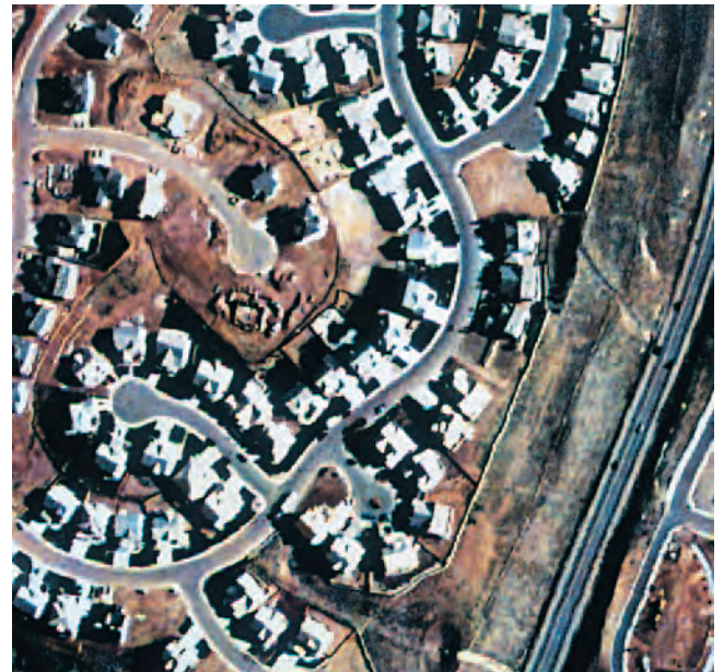
Rys. 6 (poniżej). Ortofotografia (High Definition Ortho Images – DQQ) z pikselem 1 m dostępna poprzez bazę danych Digital Globe™ (EarthWatch). Dostępne są zobrazowania ze skanowanych zdjęć lotniczych barwnych, panchromatycznych i wykonanych w podczerwieni w barwach umownych. Zdjęcie udostępnione przez EOSAT.
