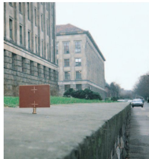
Fot. 4. Tarcza celownicza z oznaczeniem punktów celowania teodolitem i dalmierzem
