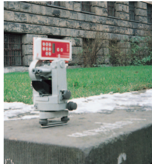
Fot. 3. Wymuszone centrowanie teodolitu na punktach bazy
