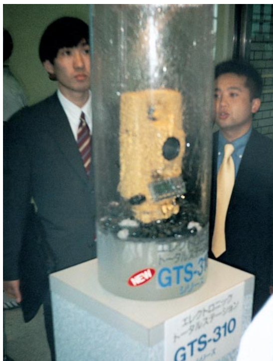
▲ GTS-310 – bryzgoszczelny tachimetr firmy Topcon spryskiwany wodą
