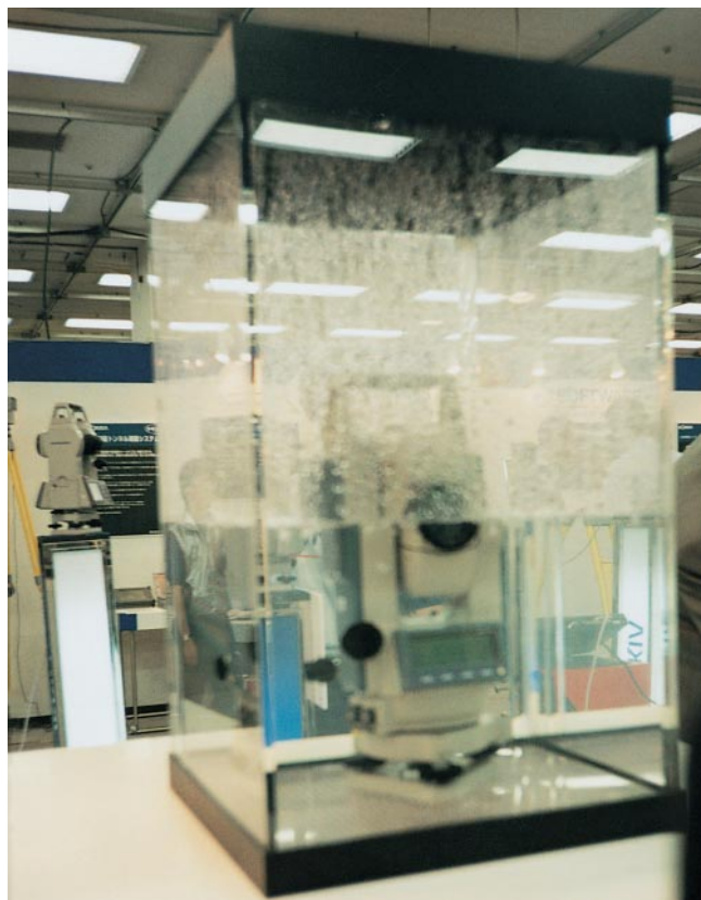
▲ SET5W – wodoszczelny tachimetr firmy Sokkia – wytrzymałe zanurzenie na głębokość do 1 metra. Na razie jest dostępny wyłącznie na rynku japońskim.
