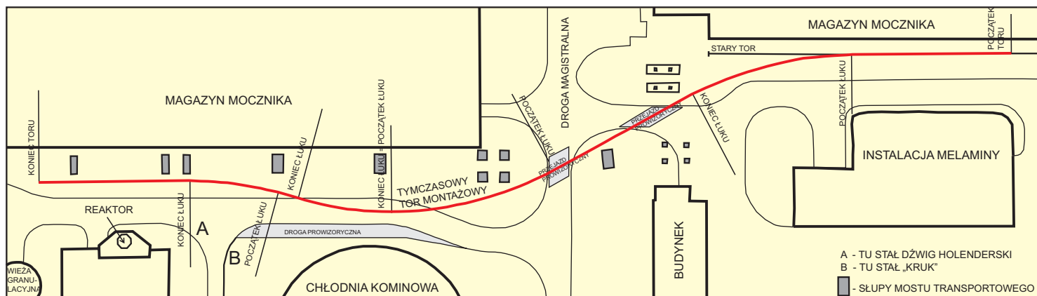
Rys. 1. Szkic przebiegu tymczasowego toru montażowego
