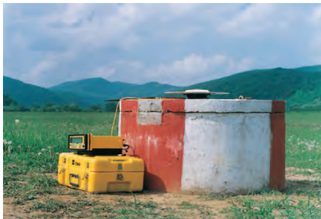
Rys. 1. Precyzyjne pomiary GPS wykonywane przez Zakład Geodezji Planetarnej CBK na punkcie sieci European Vertical Reference Network w Sanoku, maj 1997
