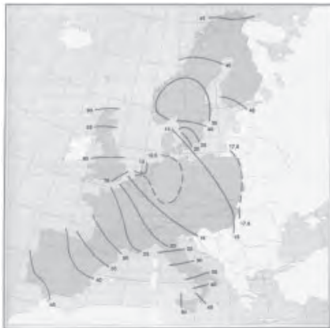
Rys. 1. Stan obecny sieci UELN-95 – izoliny (wkGal mm; 1kGal mm = ok. 1 mm) ilustrują precyzję sieci
