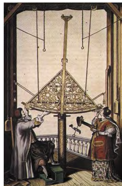
Heweliusz z drugą żoną, Elżbietą, prowadzą obserwację wielkim oktantem. Do celowania ku gwiazdom służyły przeziernice niewyposażone w lunetę. Rycina z dzieła „Machinae coelestis pars prior” (Gdańsk, 1673).
