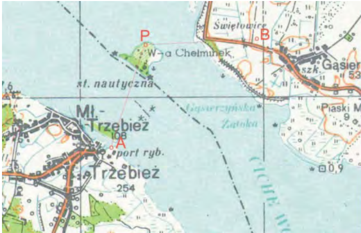
Rysunek 4. Wyznaczenie wysokości niedostępnego punktu
