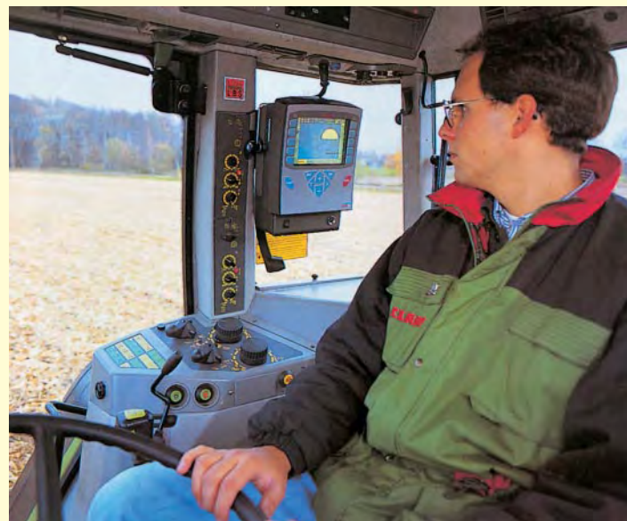
▲ Odbiornik GPS zainstalowany we wnętrzu kombajnu
