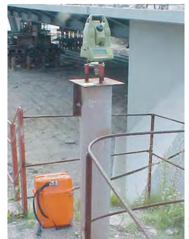
Stanowisko obserwacyjne na punkcie szczegółowej osnowy pomiarowej
