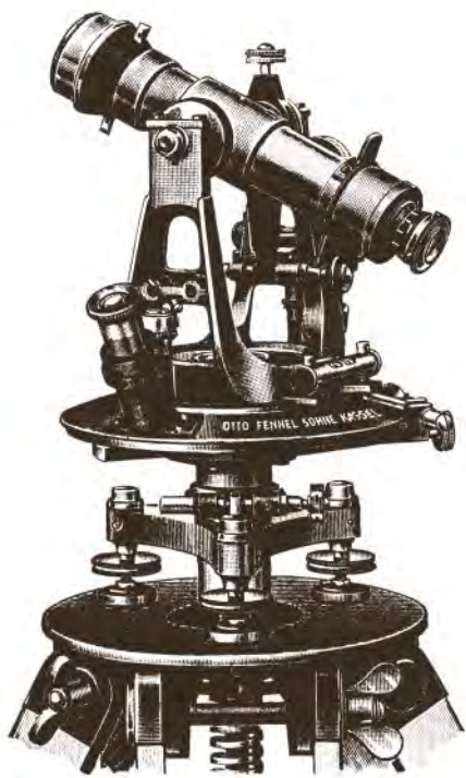
Teodolit repetycyjny firmy Otto Fenel Sohn, Kassel, lata 30. XX w.
