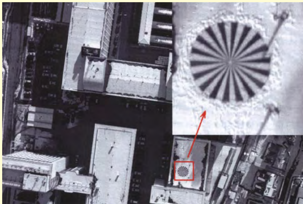
Rys. 4. Obraz otrzymany kamerą DMC 2001 (ogniskowa f = 50 mm, wysokość lotu h = 300 m, prędkość lotu v = 70 m/s, piksel 12 \mu\text{m} , piksel terenowy 7 cm, rozmycie obrazu 7 pikseli – skutecznie wyeliminowane)
