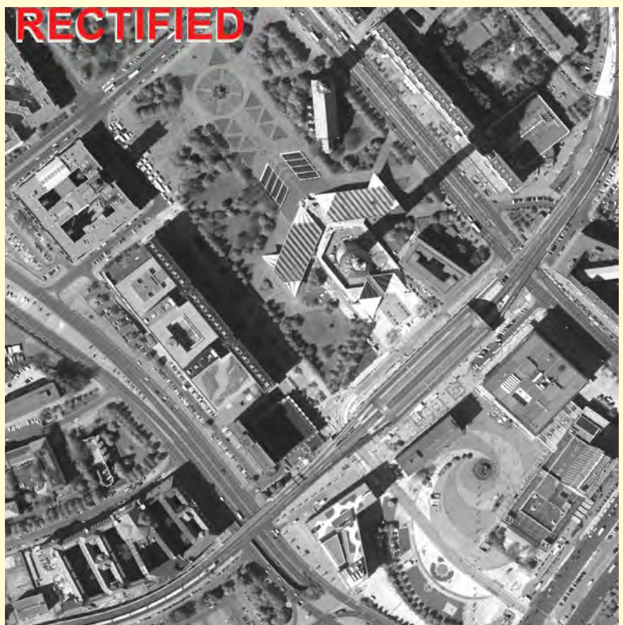
Rys. 2. Obraz otrzymany za pomocą skanera elektrooptycznego ADS40: oryginalny (bez żyrostabilizacji) i po rektyfikacji
