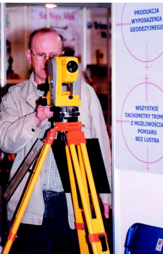
Bezlustrowy tachimetr Trimble 3305, czyli zmodyfikowana dawna Elta R55
