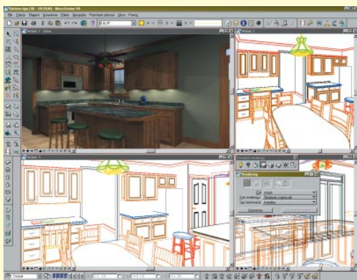
Rys. 10. Algorytmy wizualizacji umożliwiają tworzenie fotorealistycznych prezentacji projektu – efekt działania algorytmu Particle Tracing
