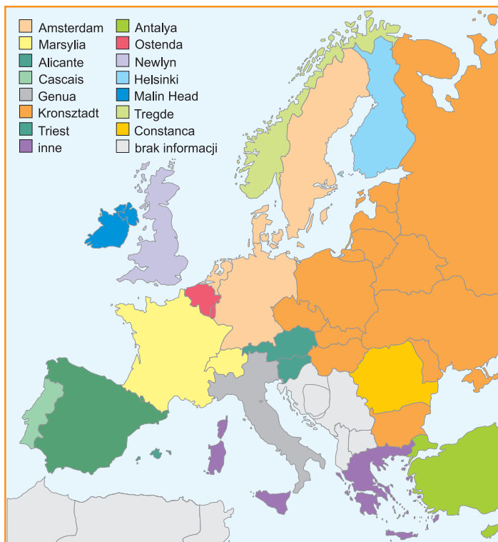
Rys. 2. Mareografy definiujące poziom powierzchni odniesienia krajowych wysokościowych układów w Europie (np. Kronszadt, Amsterdam)
