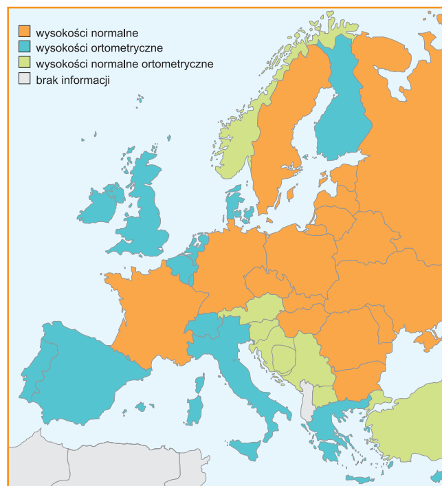
Rys. 3. Typy wysokości stosowane w krajach europejskich
