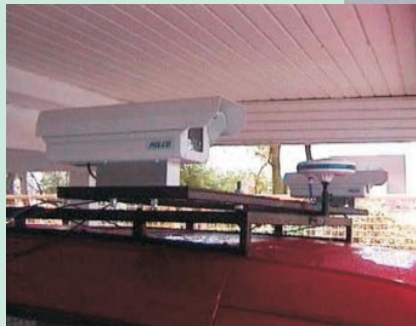
Aparaty cyfrowe i odbiornik GPS umieszczone na samochodzie pomiarowym
