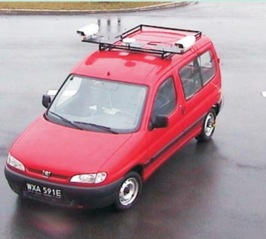
Aparaty cyfrowe i odbiornik GPS umieszczone na samochodzie pomiarowym
