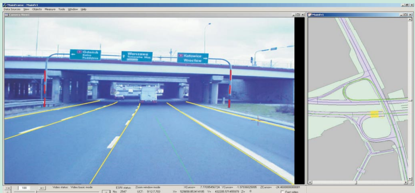
Oprogramowanie do pomiaru drogi i obiektów drogowych na stacji fotogrametrycznej
