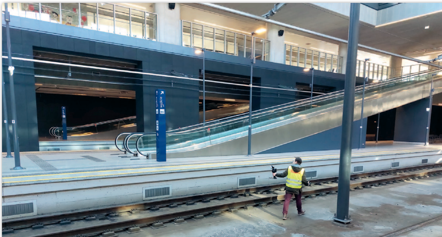
Pomiar czterech peronów i fragmentów tuneli zamknął się w czasie poniżej godziny
