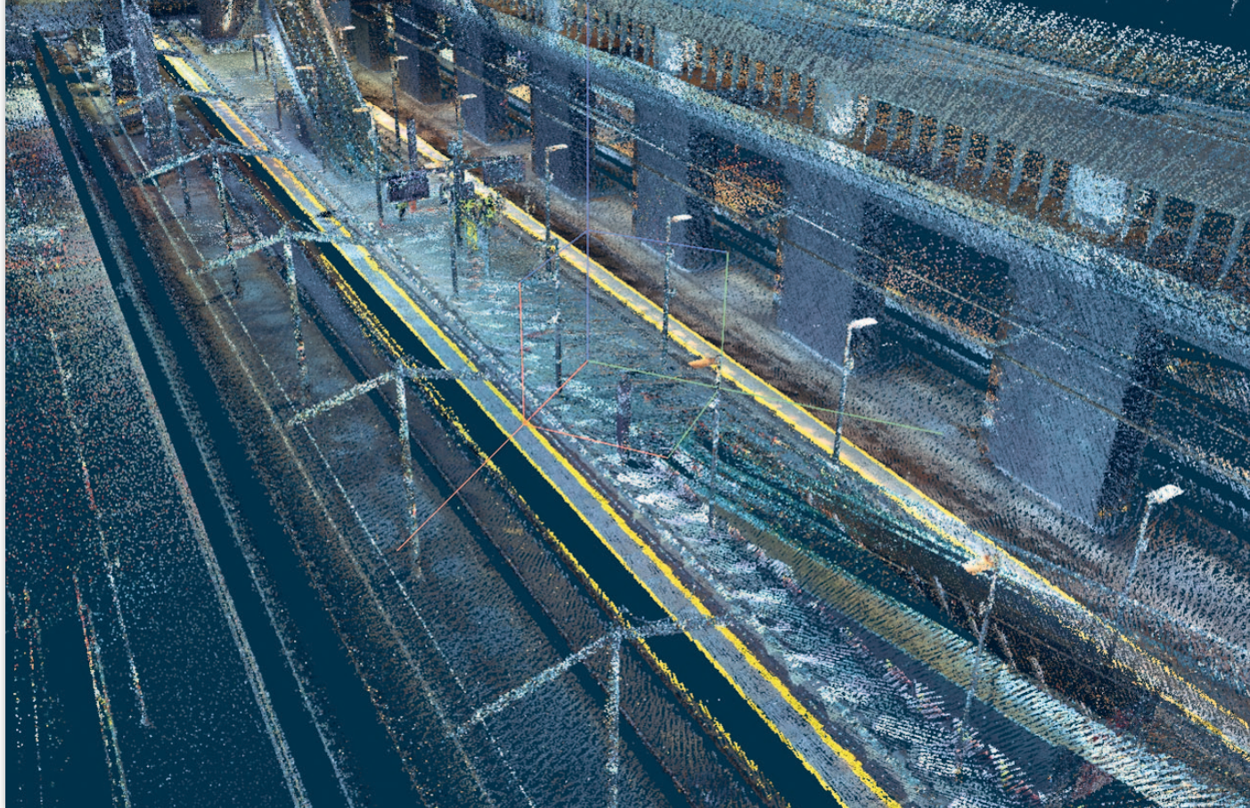
Pokolorowana chmura punktów (powyżej) oraz wynik nałożenia dwóch sąsiednich skanów (po lewej)
