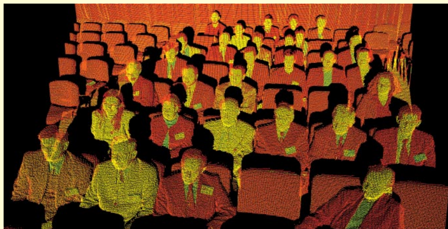
Trójwymiarowy model grupy uczestników konferencji, którzy poddali się skanowaniu instrumentem Cyrax firmy Leica Geosystems
