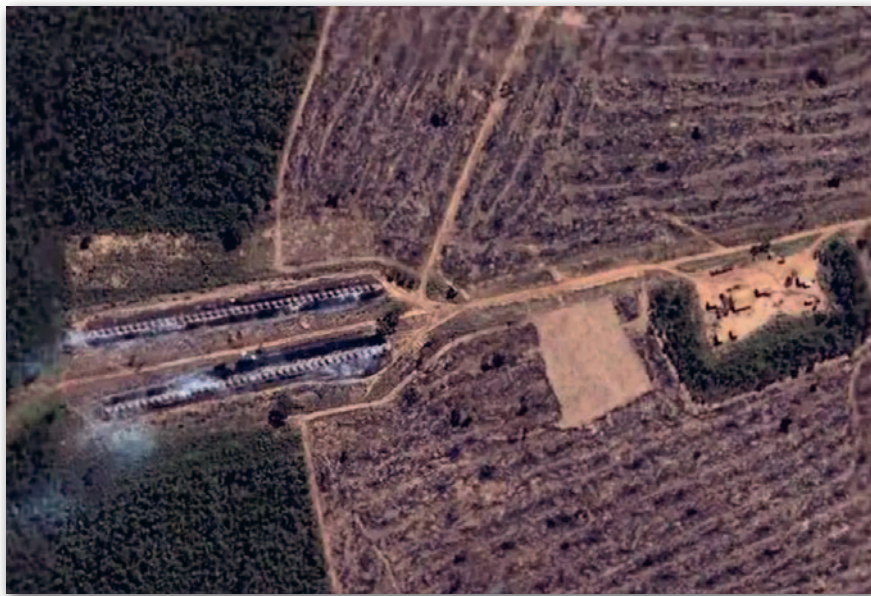
Charakterystyczny kształt manufaktury węgla drzewnego z widocznymi dymami z pieców
