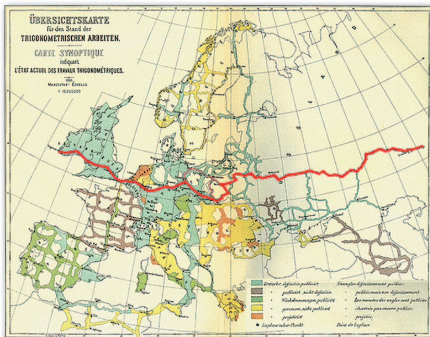
Schemat łańcucha triangulacyjnego łuku geodezyjnego równoleżnika 52°N (czerwona linia) na tle sieci triangulacyjnych państw Europy. Łuk równoleżnika 52 spinał sieci wielu państw i przecinał kilka łuków południkowych, tworząc siatkę pozwalającą na precyzyjne opisanie krzywizny Ziemi na kontynencie europejskim
