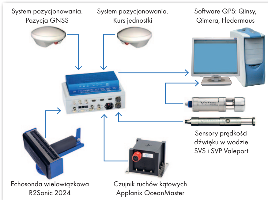
1. Schemat budowy systemu pomiarowego
