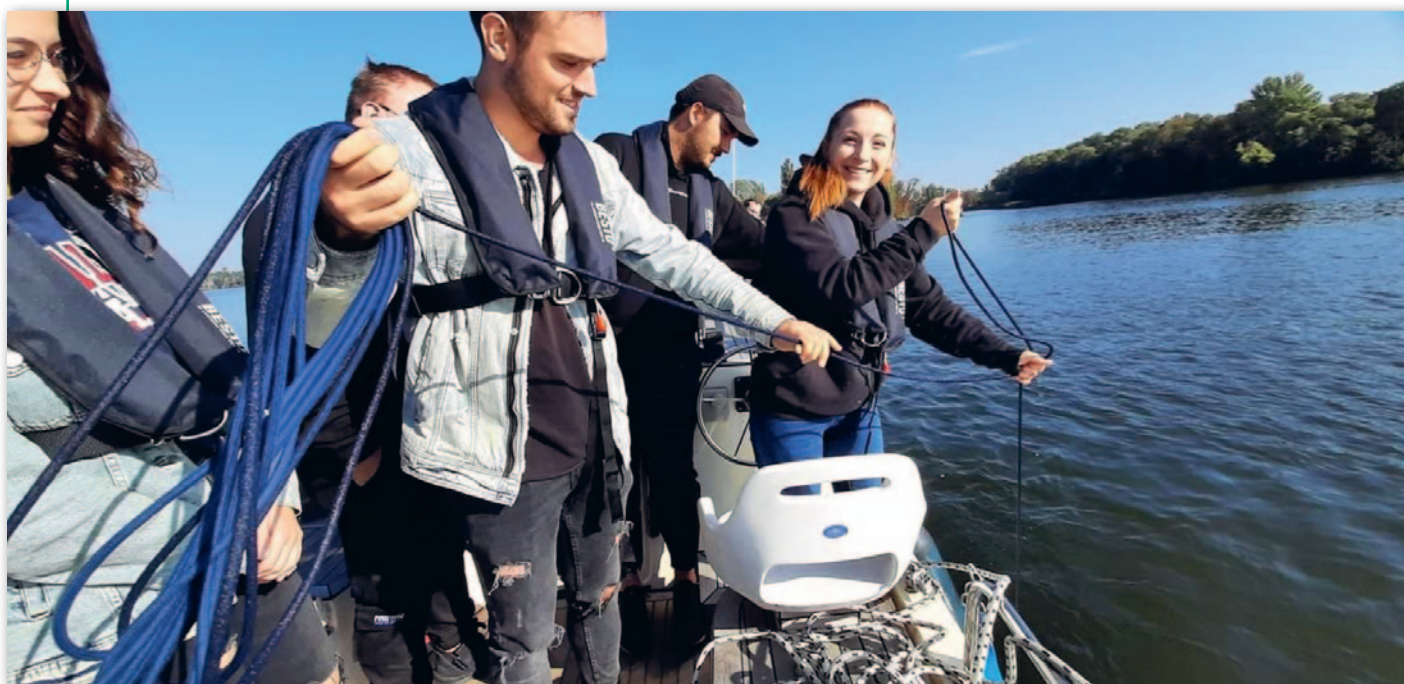
2. Opuszczanie sensora SVP na dno zbiornika w celu stworzenia profilu rozchodzenia się dźwięku przez różne warstwy wody
