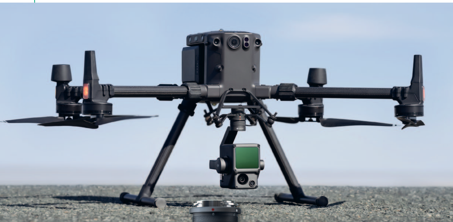
DJI Matrice 300 RTK ze skanerem Zenmuse L1
