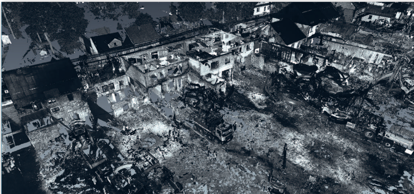
Zniszczone zabudowania wsi w chmurze punktów ze skanowania naziemnego
