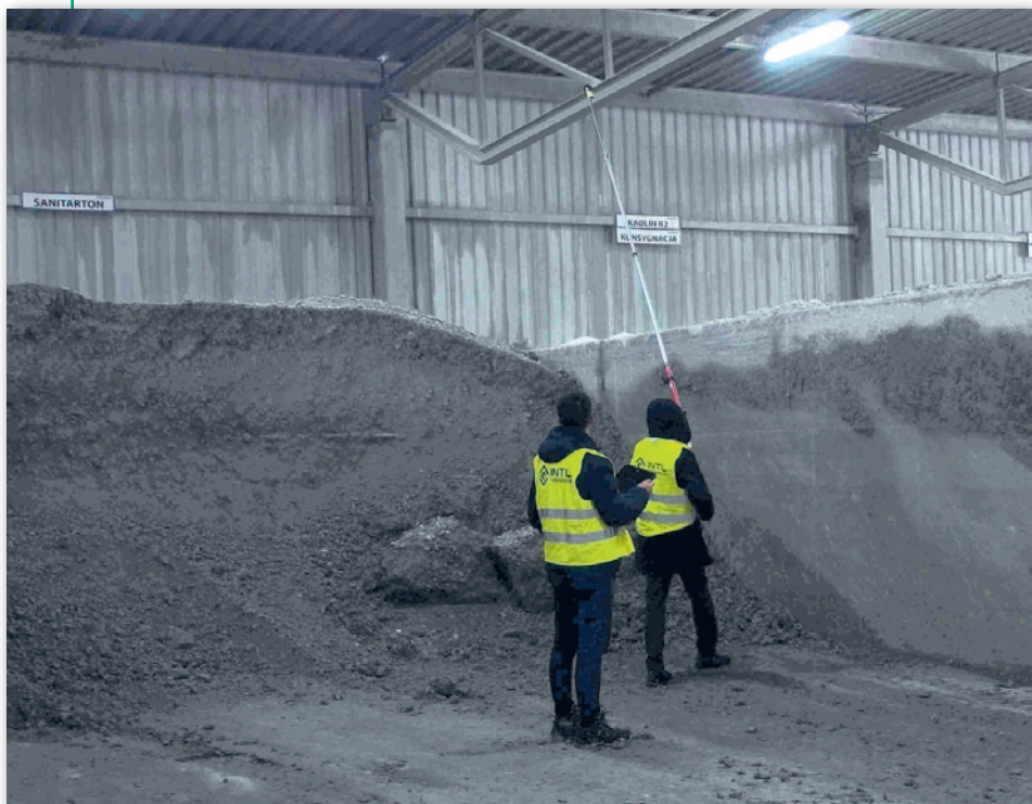
Rys. 4. Pomiar kamerą immersyjną na 5-metrowym wysięgniku
