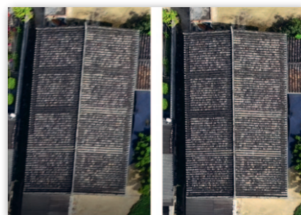
Rys. 1. Zdjęcie wykonane kamerą z migawką szczelinową z widocznym efektem rolling-shutter (po lewej) i wykonane kamerą z migawką global-shutter (po prawej)
