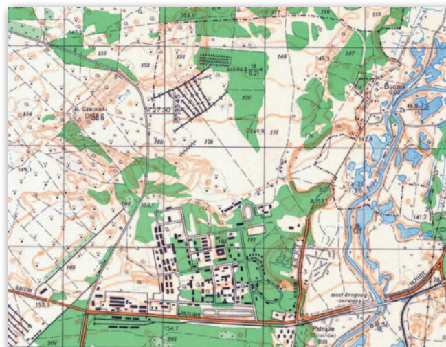
Rys. 2. Sposób przedstawiania obiektów wojskowych (poligon Pstrąże) na mapach w skali 1:25 000 różnych wydań (ark. M-33-20-C-a, Leszno Górne). Na wydaniu 1985 r. (stan 1983) brak obiektu, a na wyd. 1993 r., wzór 1990, przedstawiona pełna treść obiektu
