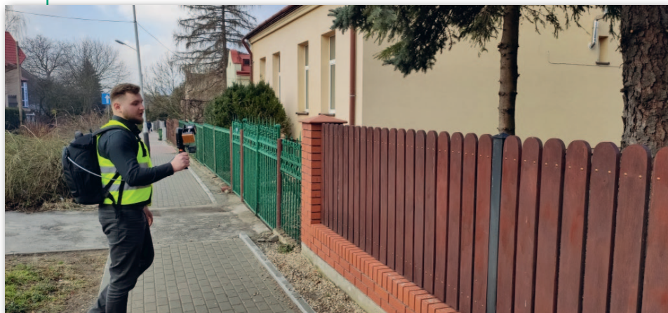
Jedną z najnowszych inwestycji spółki jest ręczny skaner laserowy ZebRevo firmy GeoSLAM
