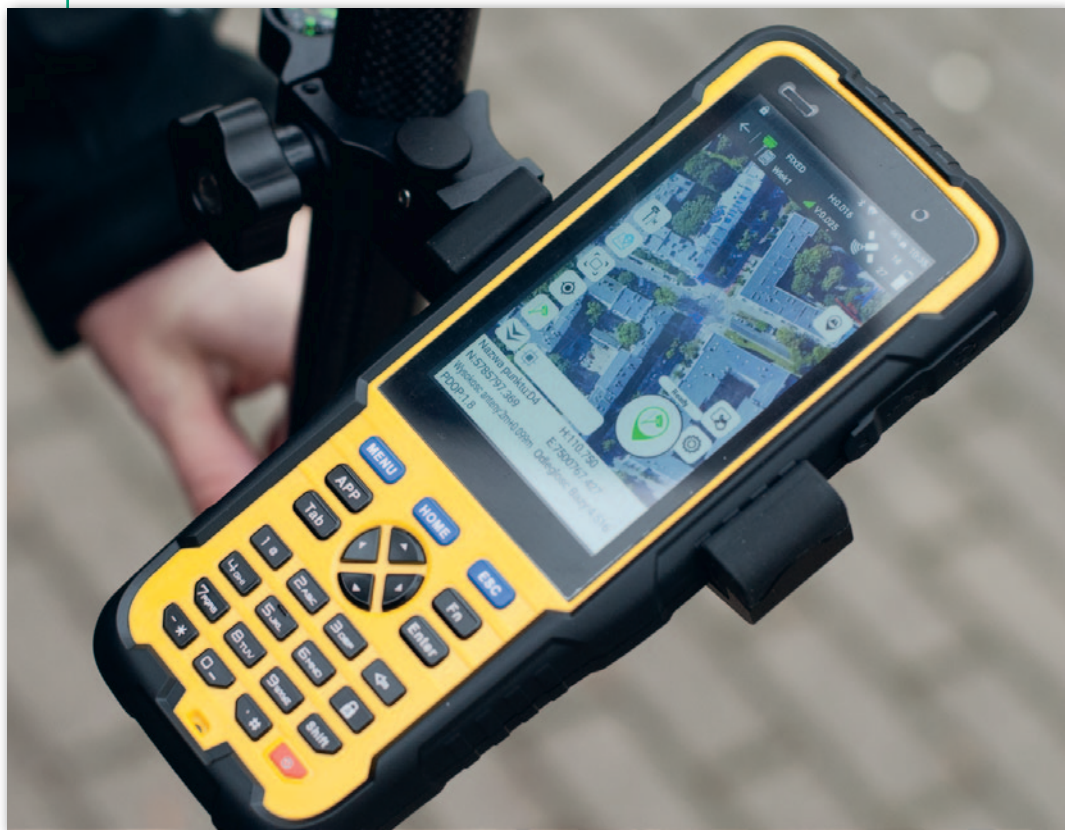
Pomiar z włączonym IMU w aplikacji Kolida SurvX 4
