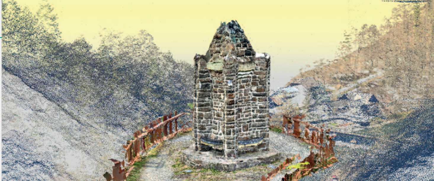
Integracja chmur punktów z lotniczego skanowania laserowego oraz chmury wyeksportowanej z aplikacji beta Capture z tabletu iPad Pro (zobacz także: youtu.be/dpl44PvOXdw )
