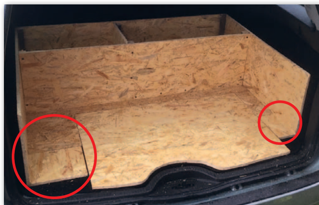
Fot. 9. Zabudowa nad kołem zapasowym
