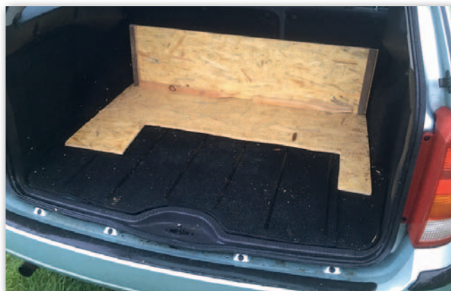
Fot. 6. Wycięcie pod koło zapasowe
