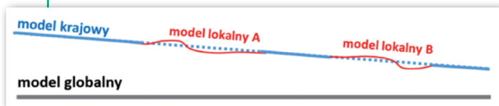
Rys. 4. Schemat uzupełnienia (modernizacji) modelu krajowego lokalnymi modelami quasi-geoidy
