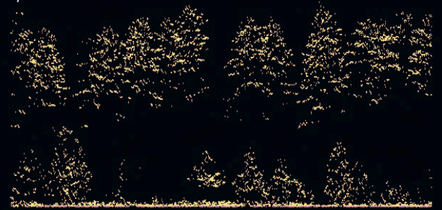
Rys. 4. Przekrój przez chmurę punktów w obszarze zalesionym: a) skaner jednofotonowy SPL100, wys. lotu 3800 m, gęstość 25 pkt/m kw.; b) skaner tradycyjny Optech Titan, długość fali 1064 nm, wysokość lotu 400 m, gęstość 39 pkt/m kw. [Wästlund, 2019]
