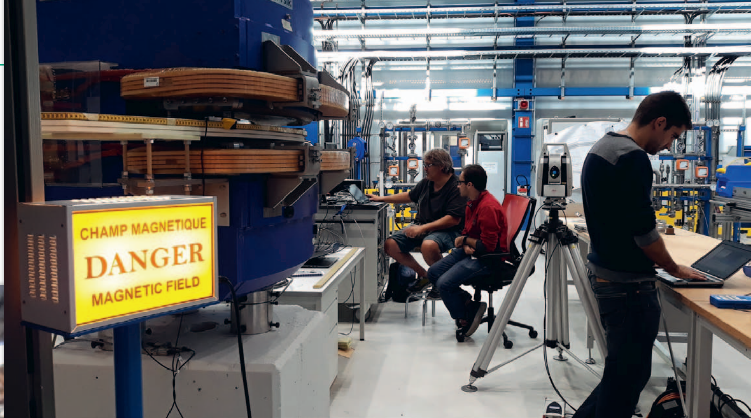
Pomiar magnesu dwubiegunowego z użyciem trackera AT401
