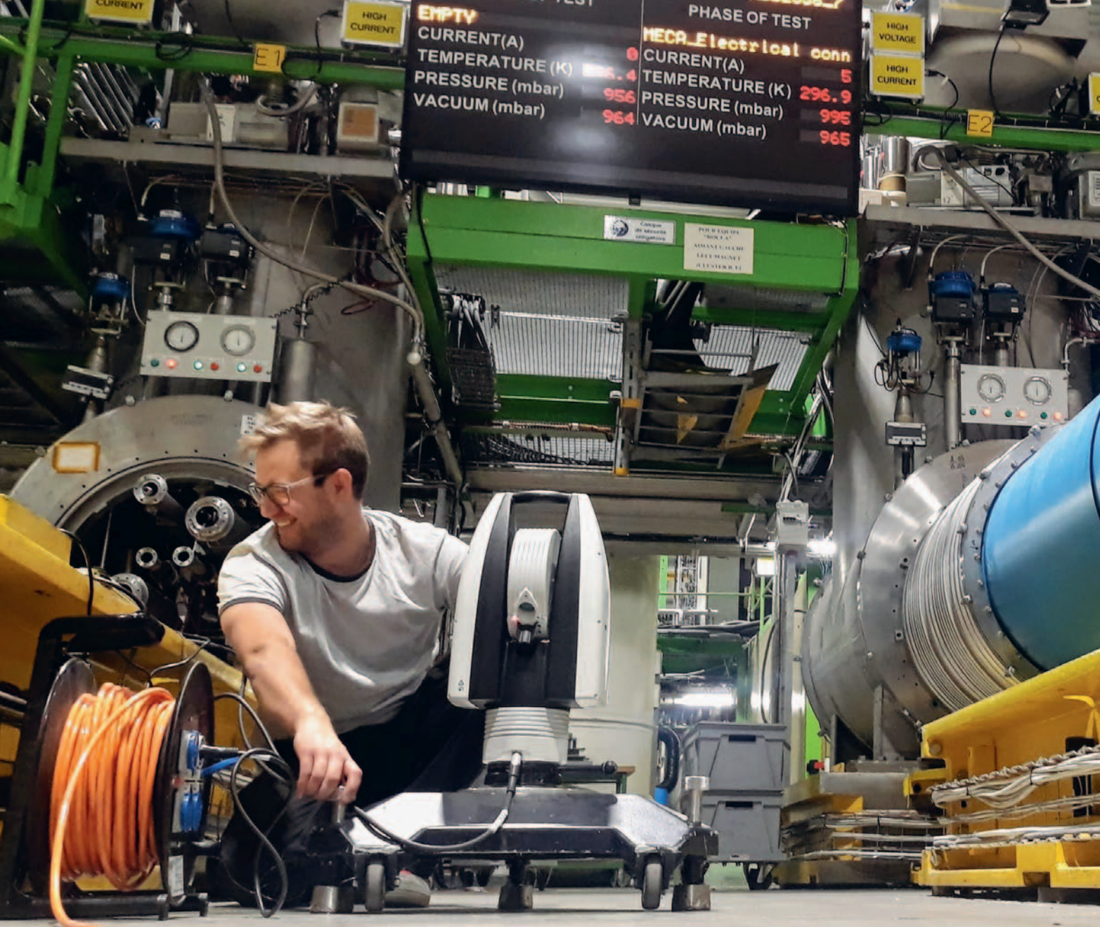
Pomiar trackerem AT960 dwubiegunowego magnesu nadprzewodzącego LHC w laboratorium SM18
