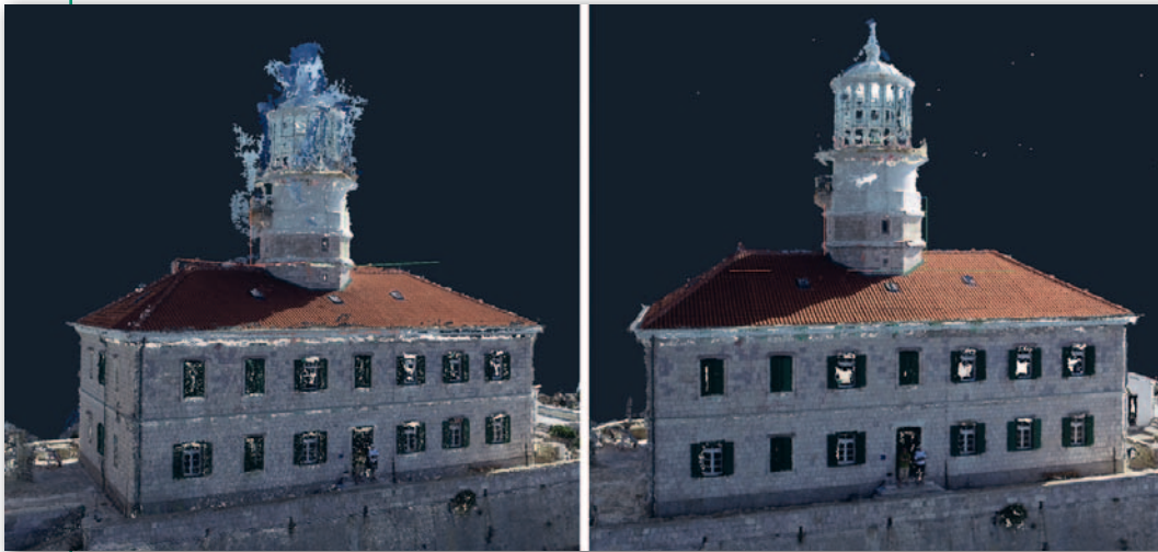
Porównanie jakości modelu 3D wygenerowanego ze zdjęć z drona przez oprogramowanie 3Dsurvey (po prawej) oraz jednego z jego znanych konkurentów (po lewej)
