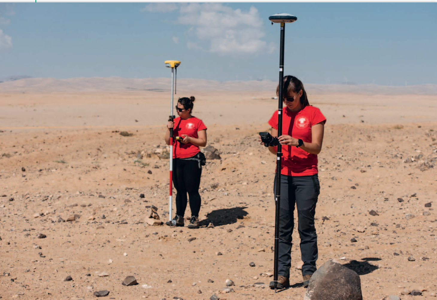
Pomiary satelitarne w celu określenia rzeczywistej dokładności odbiornika Spectra Precision SP60
