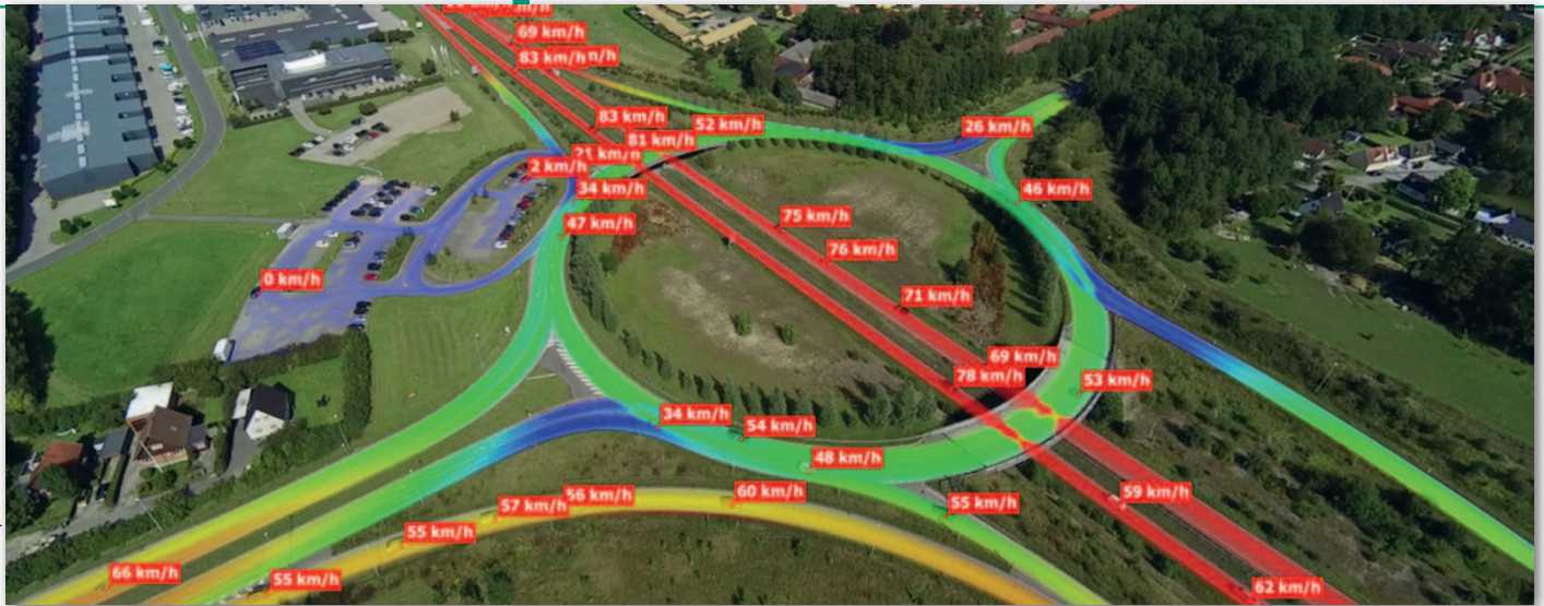
Wykorzystanie obrazu wideo z drona do monitorowania ruchu drogowego – pomysł firmy Airclip
