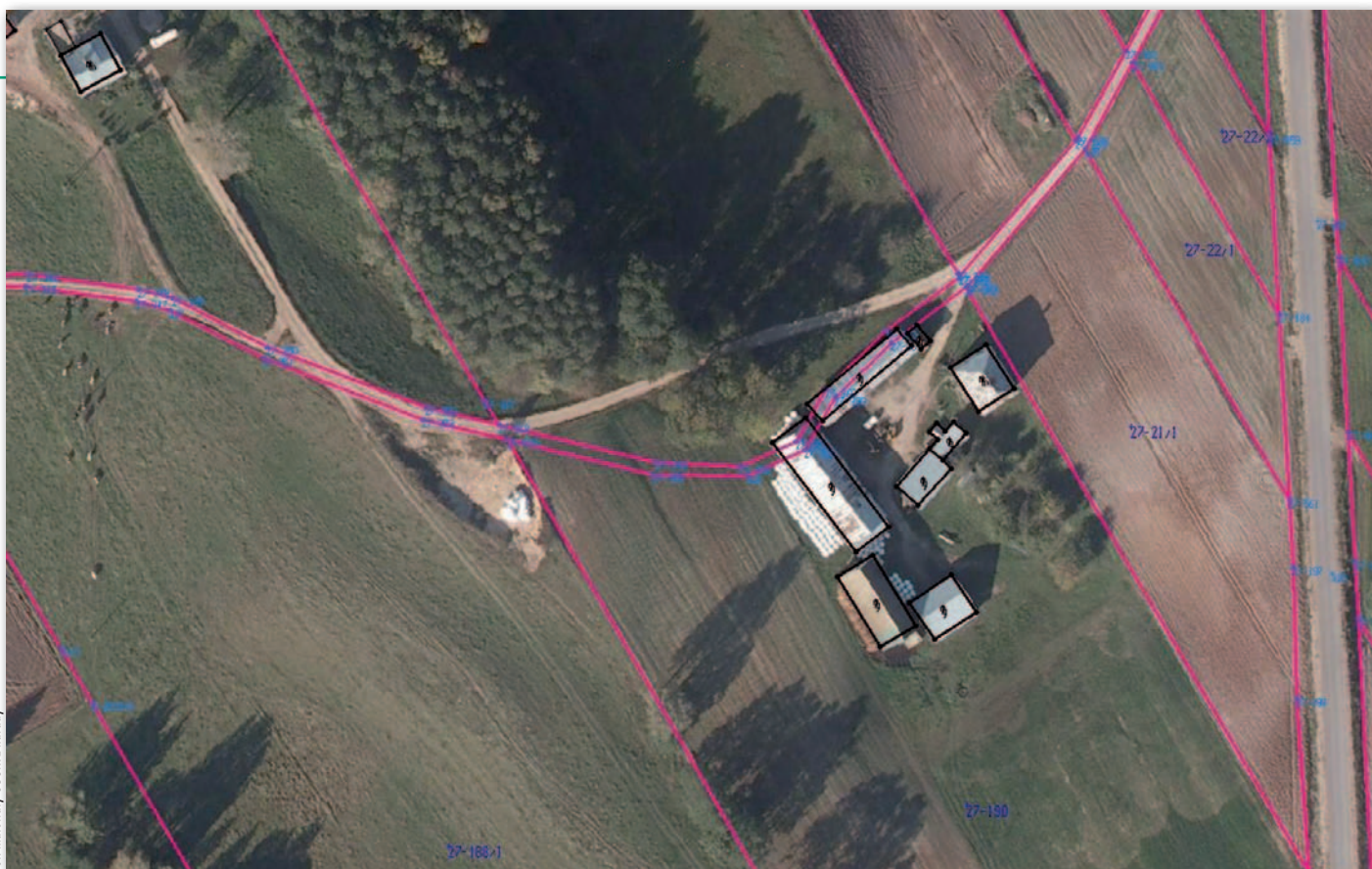
Inny częsty błąd przy modernizacji EGİB to nieuwzględnienie dróg publicznych w projekcie prac modernizacyjnych
