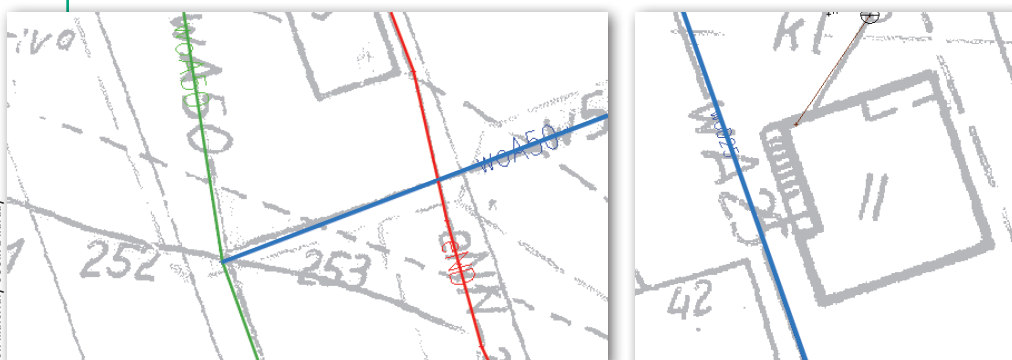
Inne błędy stwierdzane przy tworzeniu bazy GESUT to np.: brak segmentacji w miejscu rozgałęziania się przewodów o tej samej funkcji (po lewej – kolor zielony) oraz niepozyskanie obiektu z materiału źródłowego (w tym przypadku przyłącza)
