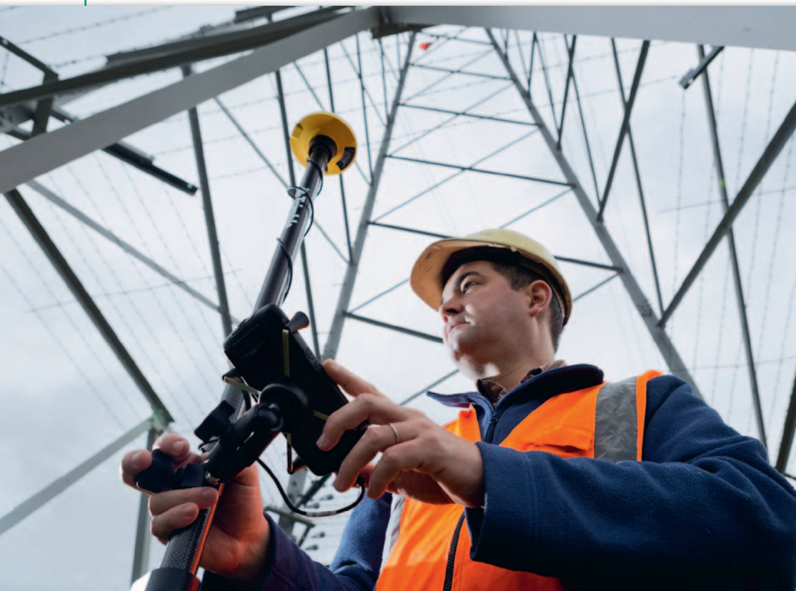
Rys. 5. W usłudze Catalyst Trimble'a do pomiaru z użyciem techniki RT-PPP w zasadzie wystarczy dowolny smartfon lub tablet oraz niewielka zewnętrzna antena satelitarna
