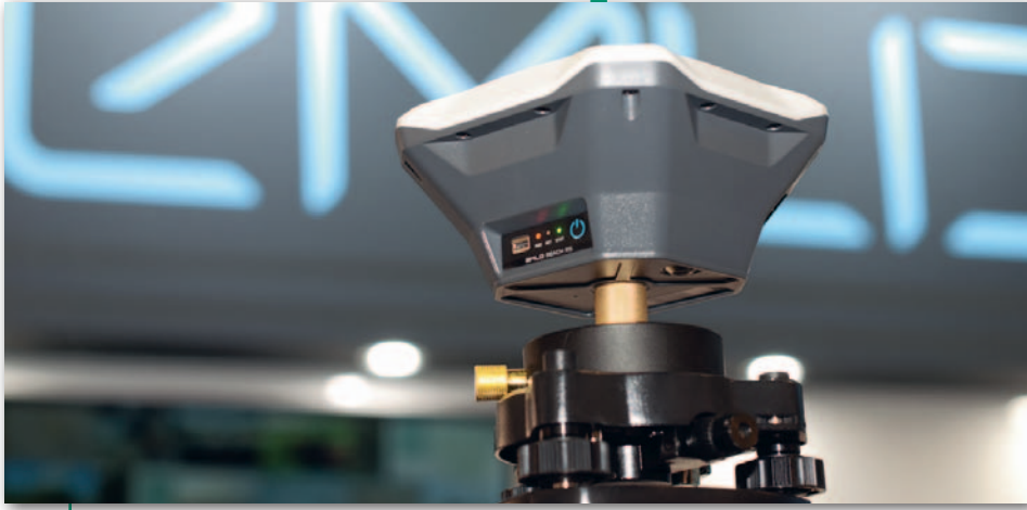
Reach RS to odbiornik RTK kosztujący zaledwie 700 dolarów
