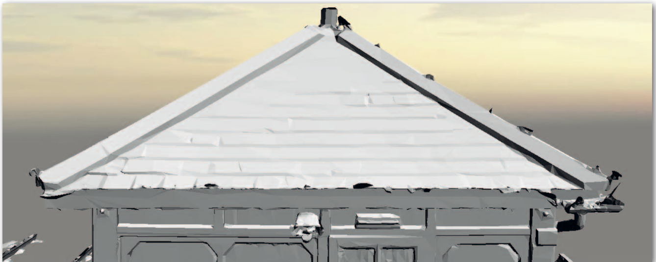
Fot. 2. Porównanie modelu wygenerowanego ze zdjęć z drona (u góry) i chmury punktów z naziemnego skanowania laserowego (u dołu)
