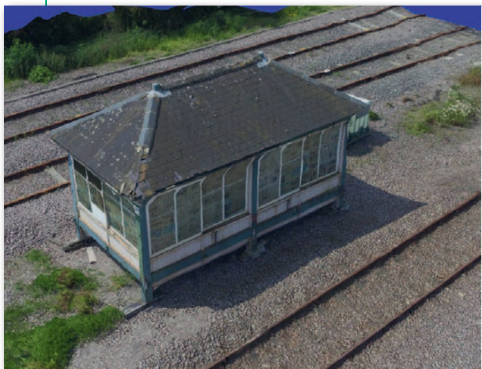
Fot. 4. Model typu mesh wraz z teksturami wygenerowany z tych samych zdjęć w oprogramowaniu ContextCapture (z lewej) i Agisoft (z prawej)
