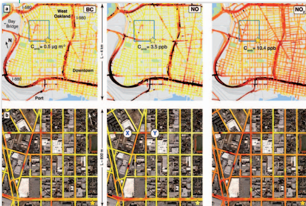
Rys. 3. Pomiary zanieczyszczenia powietrza wykonane przez samochody Google Street View
