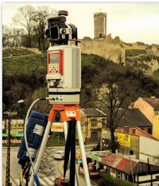
Rys. 2. Skanery Riegl VZ-400 oraz Z+F Imager 5010X podczas prac pomiarowych
