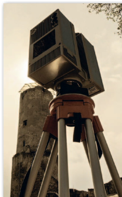
Rys. 2. Skanery Riegl VZ-400 oraz Z+F Imager 5010X podczas prac pomiarowych
