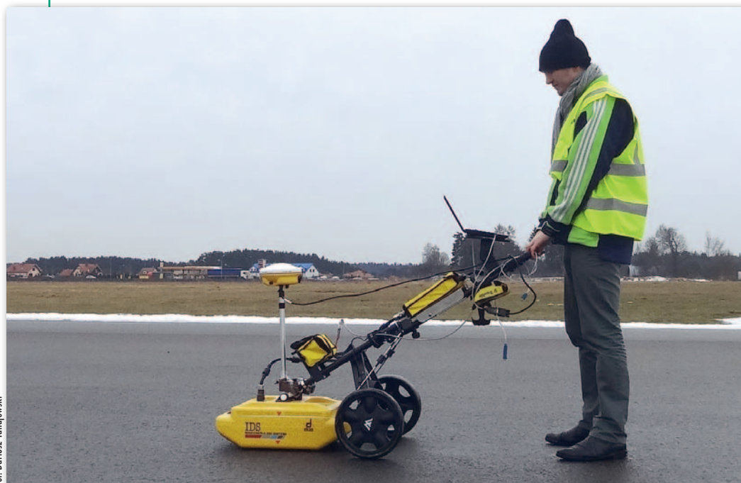
Pomiar georadarowy na lotnisku Olsztyn-Dajtki przeprowadzony przez UWM w celu zidentyfikowania przyczyn osiadania drogi startowej
