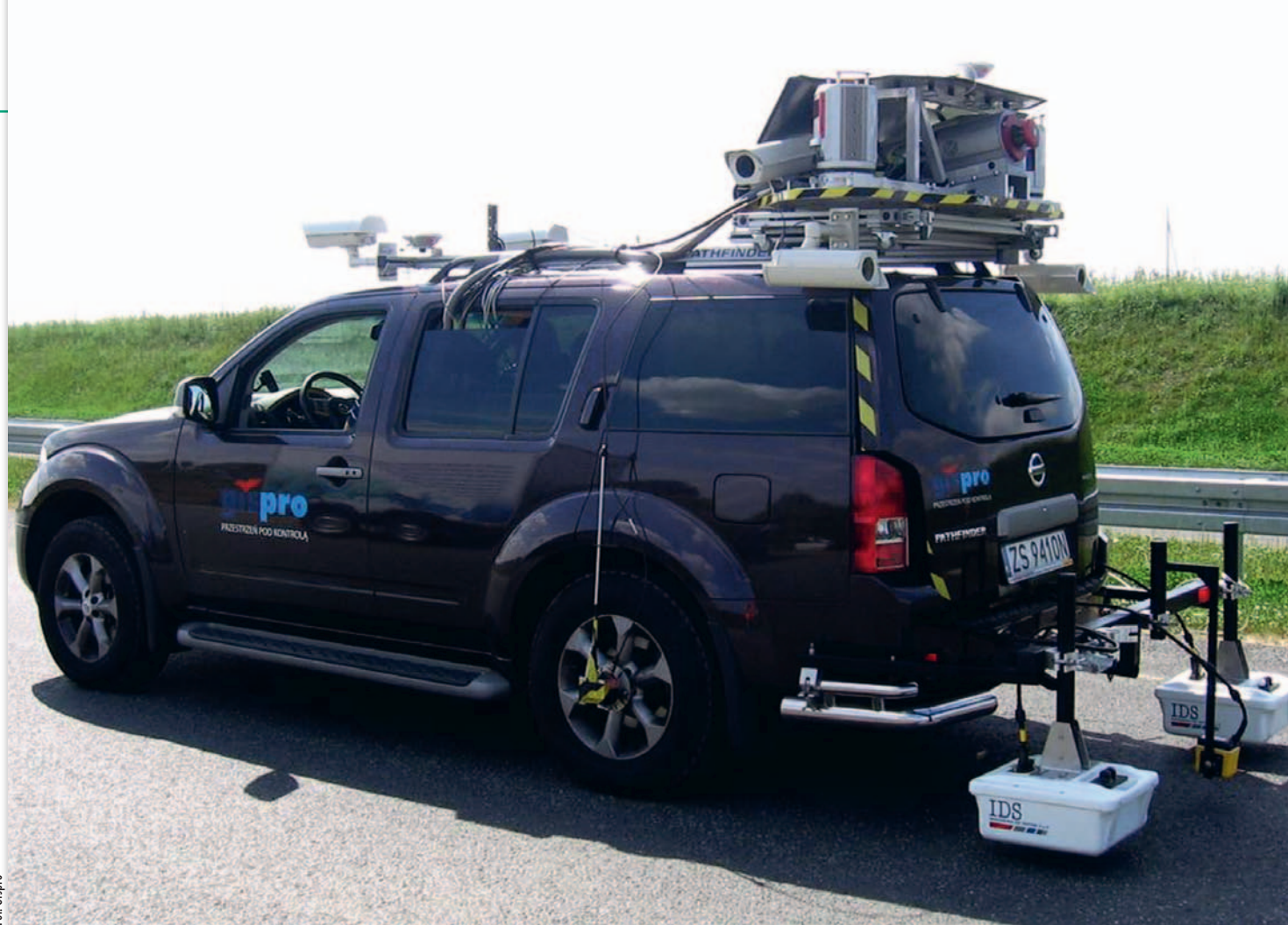
Georadary zintegrowane z mobilnym systemem skanowania użytym przez szczecińską firmę Gispro
