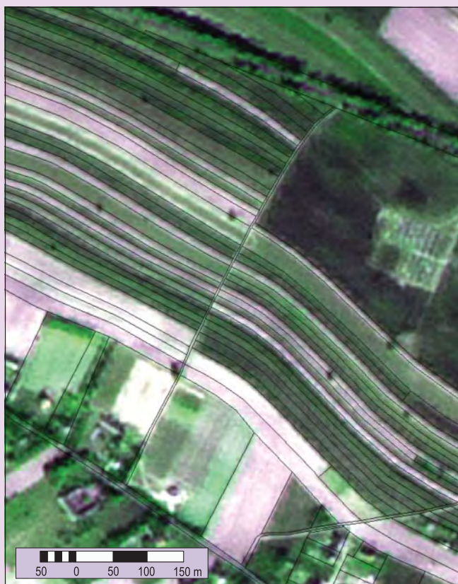
Rys. 3. Wynik połączenia zdjęcia wielospektralnego (10 x 10 m) i panchromatycznego (2,5 x 2,5 m) SPOT-5 metodą mnożnikową z nałożoną warstwą eg – gmina Wyszaków, 12 września 2002 r.
