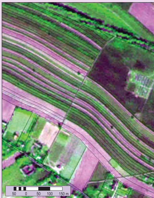
Rys. 4. Wynik połączenia zdjęcia wielospektralnego (10 x 10 m) i panchromatycznego (2,5 x 2,5 m) SPOT-5 metodą transformacji PCA z nałożoną warstwą eg – gmina Wyszaków, 12 września 2002 r.
