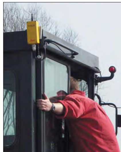
Radiomodem systemu Leica na dachu równiarki
